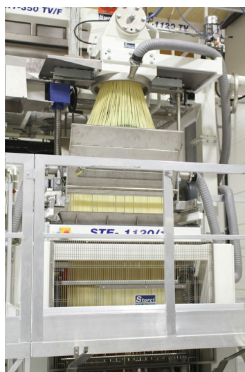
Applicazione STE 1120 su linea Omnia con spanditore a "fungo"
