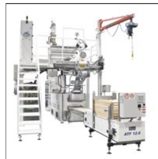
Alimentación del bastidor en la línea de pasta corta
