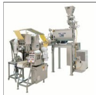
V90.1 TV accouplée à la machine à raviolis DS
